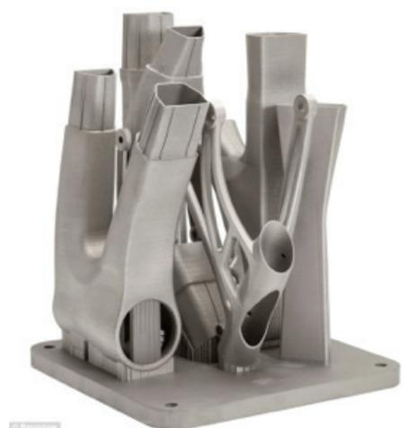
積層造形で製造した自転車フレームの部品
